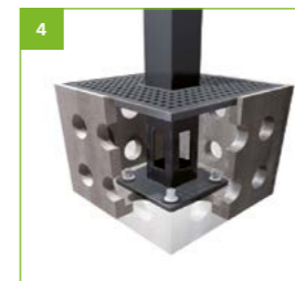
Concrete foundation / vegetation support: Custom concrete foundation designed to mount the column. Dimensions: 760x760x580mm / 29.9" x 29.9" x 22.8" Closed by a perforated aluminum grid Grid thickness: 25mm / 1" Massif de liaison au sol / Support végétation En béton, équipé pour recevoir le mât Dimensions : 760x760x580 mm Fermé par une grille ajourée en découpe d'aluminium (épaisseur 25 mm)
