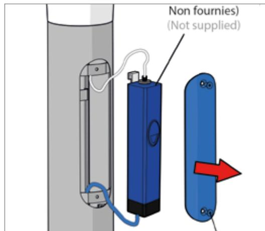
Ouverture de la porte via 2 vis BTR pour accès au logement électrique.
