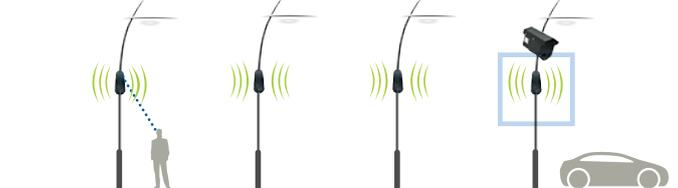
**Gerät zur Vernetzung verschiedener Tätigkeitsfelder der Stadt mit dem sensorgesteuerten Energiesparsystem SensyCity, um die Straßenbeleuchtung den verschiedenen Informationen entsprechend einzustellen und zu optimieren.**
